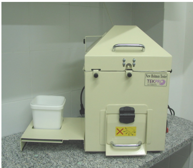
Figura 12: Tester per pellet New Holmen della ditta TEKPRO
